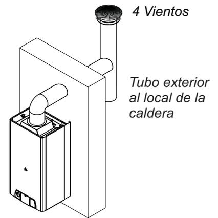
Para evitar la corrosión de los tubos de la salida de humos, recomendamos utilizar acero inoxidable AISI316 de un espesor mínimo 0,5mm.
