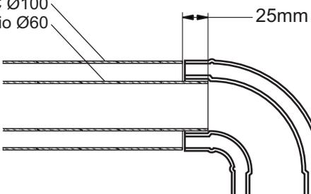
La instalación de la salida de humos para un sistema concéntrico contempla un codo con brida de 90°, un máximo de 5 metros de conducto para calderas a gas natural, 3 metros de conducto para calderas a gas licuado; y un sombrerete terminal. Cada codo de 90° adicional equivale a una reducción de longitud del conducto de 1,30 mts.
