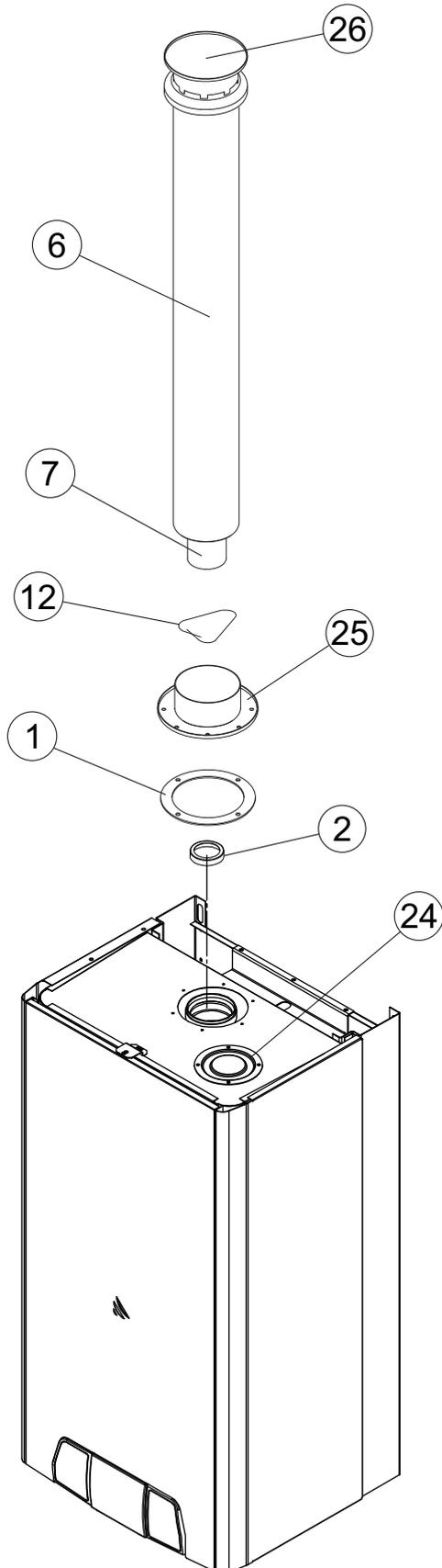
Detalle de la distancia que debe sobresalir el tubo de aluminio del concéntrico de PVC para poder realizar la fijación del conjunto al terminal de la salida de humos y de la Caldera.
