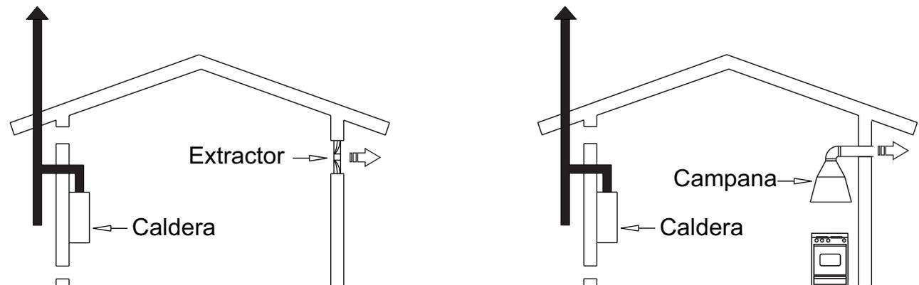
**Atención: No es recomendable instalar la caldera en un local donde hay campanas, extractores de aire o cualquier otro conducto de ventilación (como chimeneas de parrillas etc.). En caso contrario, deberá verificarse que funcionando simultáneamente con la caldera, no afecten el tiraje de la misma.**
