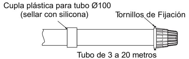
La instalación de la salida de humos para un sistema de conductos separados contempla los tubos de expulsión de gases (Ø80) y de aspiración de aire (Ø100) y el sombrerete terminal. Los conductos pueden ser de hasta un máximo de 20 mts cada uno o su equivalente (cada codo de 90° equivale a una reducción de longitud del conducto de 1,30 metros).
