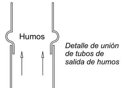
En el caso de tramos de la salida de humos al exterior, se deberá proteger del agua de lluvia la aislación térmica con un tubo camisa de chapa de acero inoxidable, chapa de acero galvanizada o aluminio, asegurando la estanqueidad del mismo.
