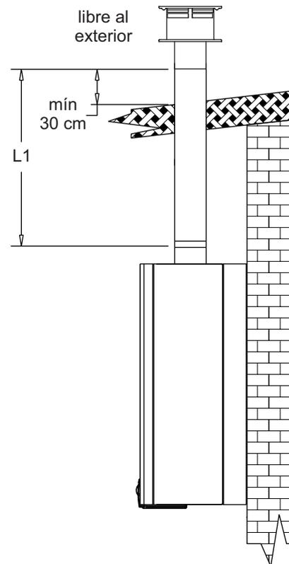
**Nota:** Obsérvese que en los ejemplos dados se determinan distancias mínimas que deben respetarse en cualquier otro tipo de configuración para asegurar la buena evacuación de los productos de combustión.
