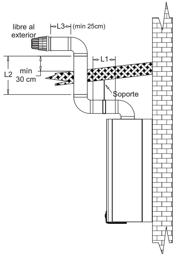
**Nota:** Obsérvese que en los ejemplos dados se determinan distancias mínimas que deben respetarse en cualquier otro tipo de configuración para asegurar la buena evacuación de los productos de combustión.
